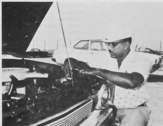
Silvio Cijntje di E. R. Safety ta inspecta e cable di batería pa preveni un corto circuito cual lo por causa un candela.
